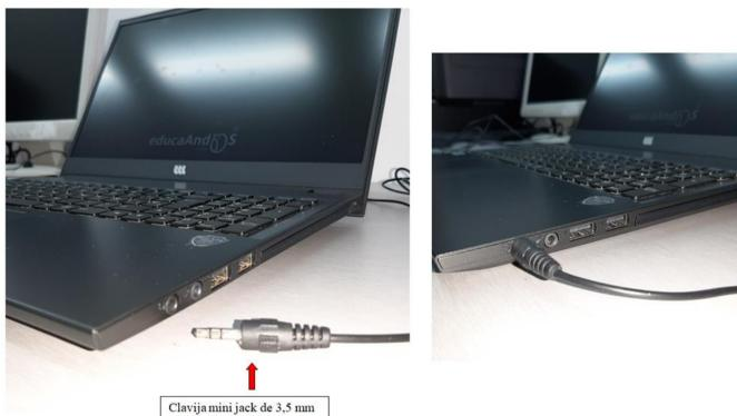
En el caso de tener pizarra digital se puede conectar un cable minijack de 3,5 mm a la salida de la pizarra digital aunque para el caso de ver un video es mejor poner directamente el video a través del USB de la pizarra digital que lleva la imagen y sonido incorporado.
