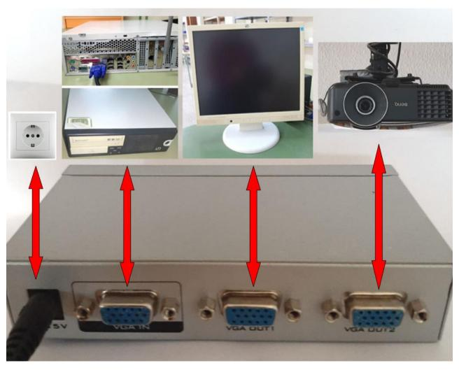
En el caso del splitter de la derecha las conexiones serian las siguientes:
