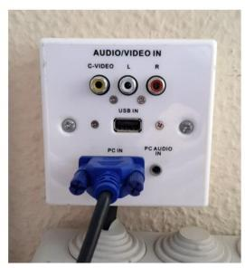
Para esto será necesario tener un cable VGA (macho-macho) que conectaremos desde la salida VGA de la pared a la salida VGA de nuestro portátil (podemos usar algún un adaptador VGA, como el de la imagen, si la salida VGA es diferente)
